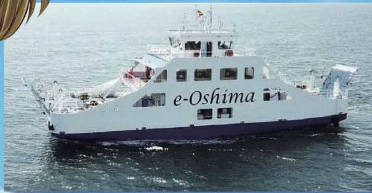
▲電池駆動船(国内最大級) 株大島造船所 「日本初自動操船機能を有する完全バッテリー駆動船"E/V e-Oshima"の紹介」
