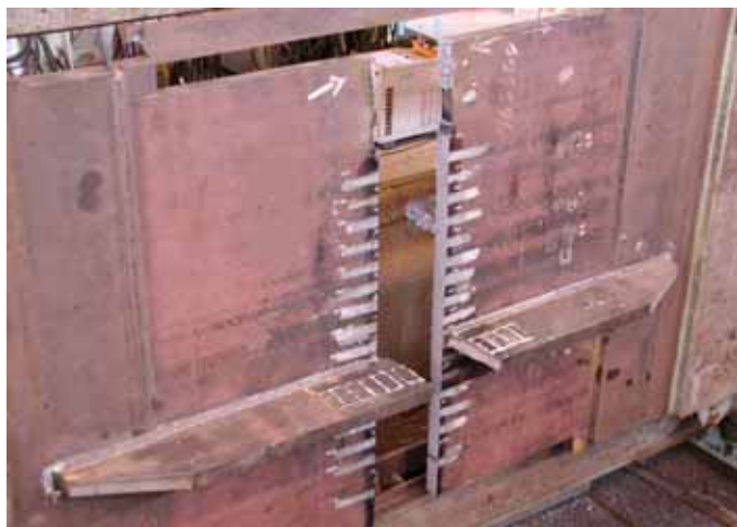
写真-4.1 溶接熱影響部の大型 ESSO 試験結果
