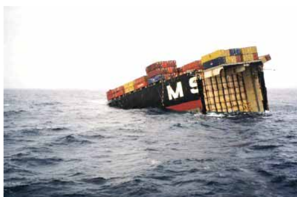
写真-1.1 船体折損事故を生じた MSC Carla 号 ( http://www.containershipping.nl/casualties.html )
