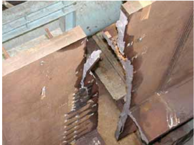
写真-4.2 母材の大型 ESSO 試験結果
